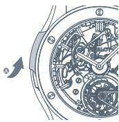
Spingere il cursore (A) da ore 9 verso ore 10. La corsa del cursore varia in base alla lunghezza della suoneria. Il cursore dovrà essere fatto scorrere fino all'arresto. Si raccomanda di non forzare una volta raggiunto l'arresto.
