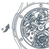
Presionar el cerrojito (A) de las 9 h en la dirección de las 10 h. Tenga en cuenta que el recorrido del cerrojito de armado varía en función de la duración de la sonería. El cerrojito debe presionarse hasta el tope. Le recomendamos que preste especial atención para no forzar el mecanismo al alcanzar dicho tope.
